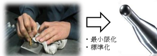
図3 5軸切削加工による金型手磨き工程の削減
